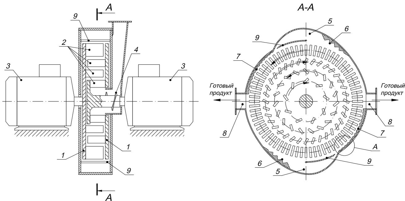
Рисунок. 1. Дезинтегратор с эффективной камерой помола.
